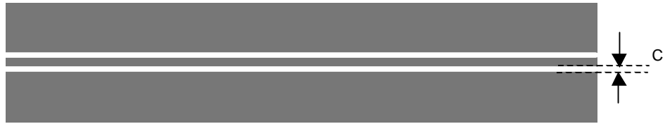
Figura N° III-2: Líneas centrales de trazo continuo.
